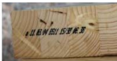
Εικόνα 2. Σφραγίδα πιστοποίησης αντοχής και ποιότητας, στο σόκορο ξύλινου μέλους
